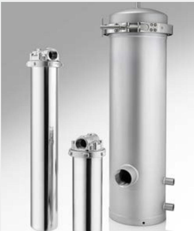
Die 1er-Version besteht aus Kopf und Sumpf, welche mit einer Verschlussmutter verschraubt werden. Der Ein- und Auslass ( $\frac{3}{4}$ " oder 1" Muffe) sind im Gehäusekopf gegenüberliegend angeordnet. Die Abdichtung erfolgt durch eine NBR-O-Ringdichtung (EPDM oder FPM auf Wunsch). Das Gehäuse kann über eine 3/8" Muffe am Boden entleert werden. Eine Befestigungskonsole für die Wandbefestigung ist als Zubehörteil lieferbar.
